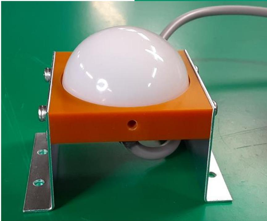
1. 出力感度 : 0-200mV(1400W/m<sup>2</sup>にて200mV)
